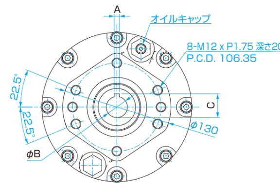
※ご使用前に必ず、ギヤ油工業用2種 (JIS K 2219) ISO VG150相当油を200cm<sup>3</sup>給油してから運転してください。
