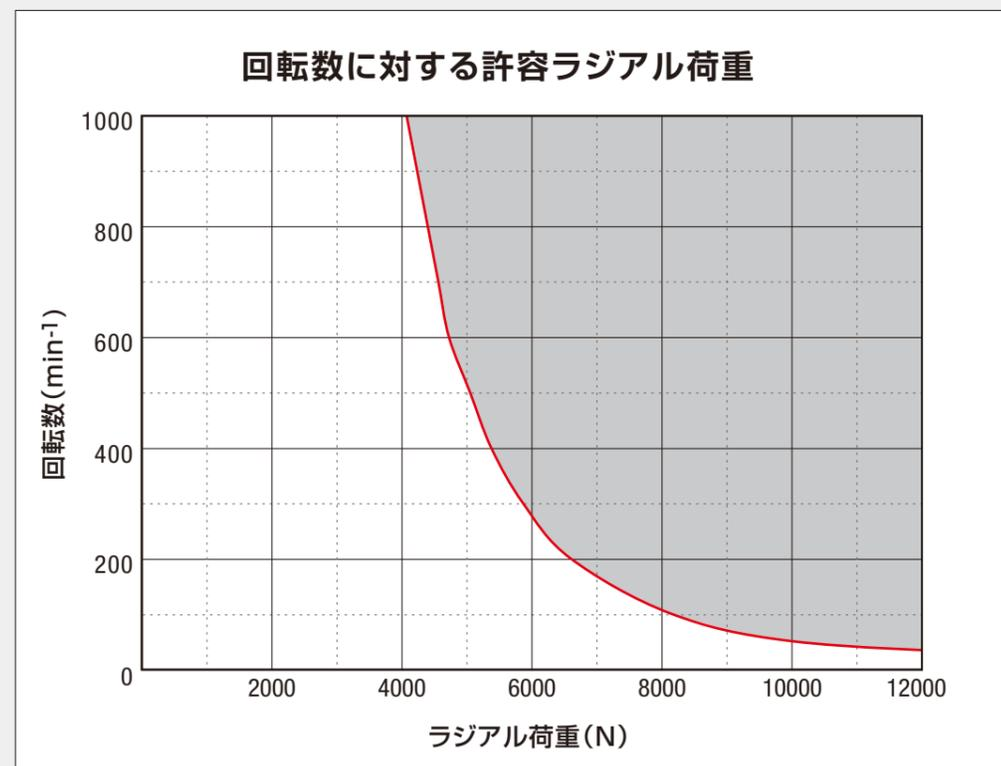
本ラジアル荷重と同時に5000Nまでのスラスト荷重が許容されます。
