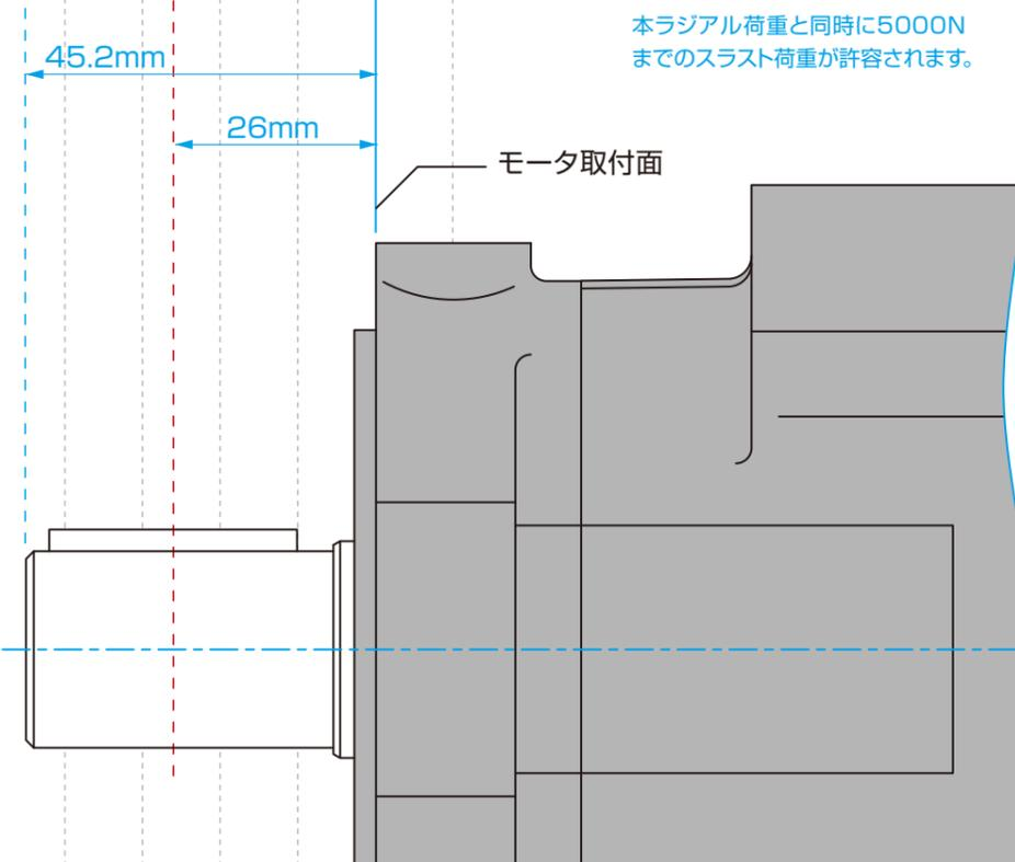
本ラジアル荷重と同時に5000Nまでのスラスト荷重が許容されます。
