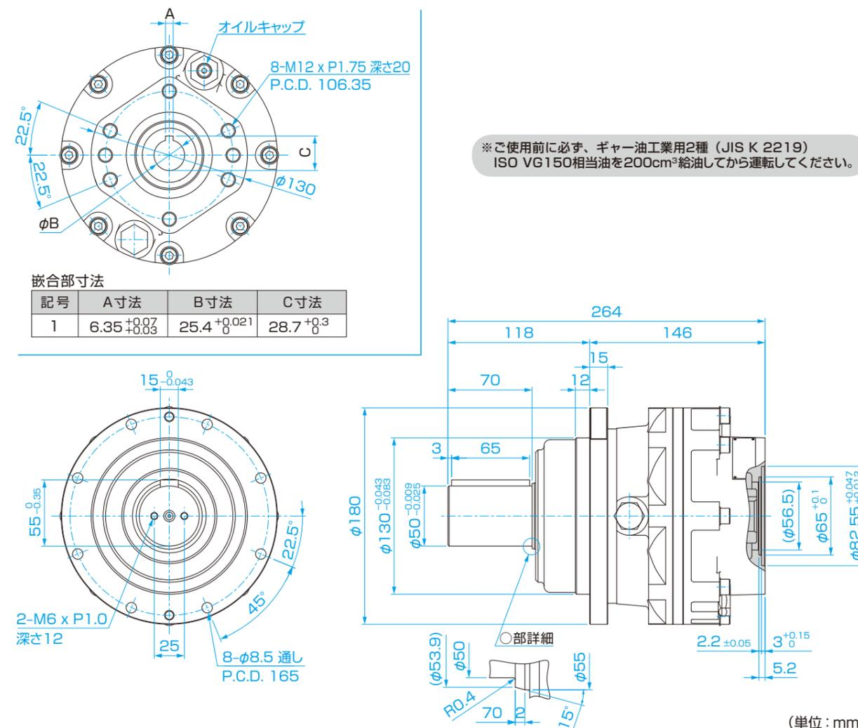
※ご使用前に必ず、ギヤ油工業用2種 (JIS K 2219) ISO VG150相当油を200cm<sup>3</sup>給油してから運転してください。
