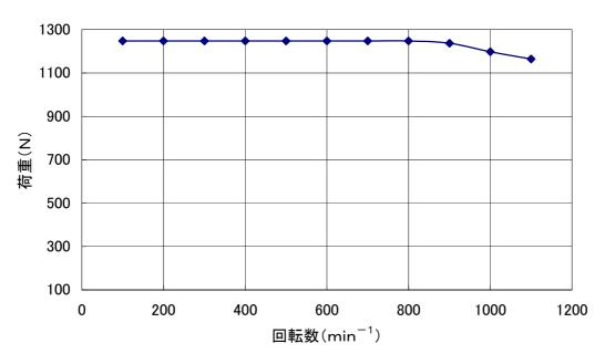
ORB-M スラストベアリング2000時間のB-10 (スナップリングの強度を考慮し最大スラスト荷重を6940Nとする)
